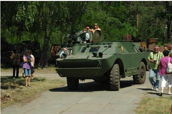
russ./NVA Panzerjäger SPW 40 P2 als Startfahrzeug 9P133 mit 6 Startschienen für Panzerabwehrkrakete 9M111
